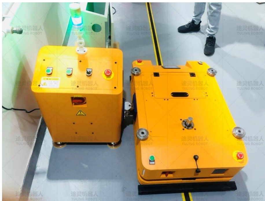
智能充电桩侧充电刷+AGV车载充电极板+AGV电池模组
